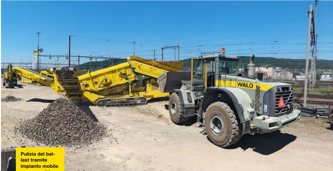
Pulizia del ballast tramite impianto mobile con capacità di 300 tonnellate/ora
